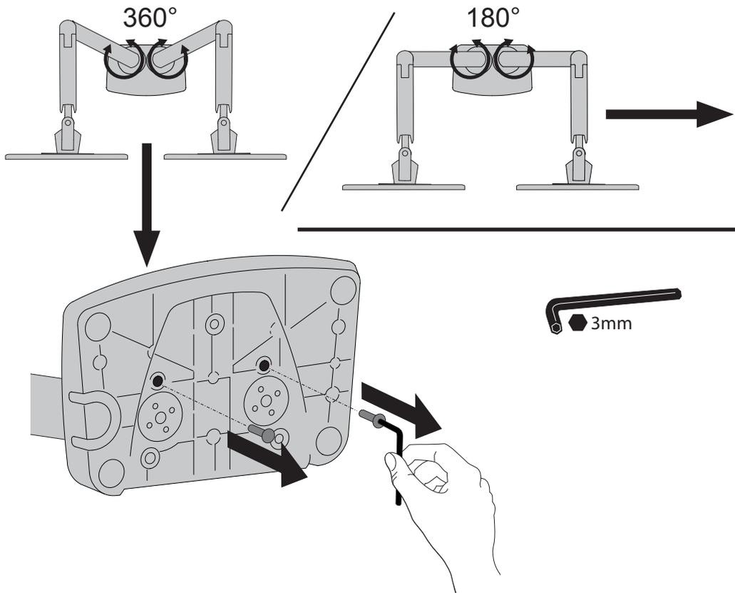
Hoe de schroeven om het draaien te stoppen te vervangen (Armen moeten zich in een opwaartse positie bevinden)
