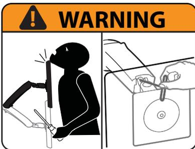
**WARNUNG!** Gefährdung durch gespeicherte Energie: Der Arm-Mechanismus der Arbeitsfläche steht unter Spannung und bewegt sich von allein und schnell nach oben, sobald das befestigte Gerät abgenommen wird. Entfernen Sie aus diesem Grund die Geräte nur, wenn sich der Arm auf der höchsten Position befindet! Eine Missachtung dieser Anweisung kann zu ernsthaften Verletzungen und/oder Beschädigungen am Gerät führen.
